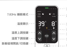
通電指示燈 2Hz 深睡模式 定時單位 (小時) 加熱工作指示燈 定時上調按鍵 定時下調按鍵 - - 電源開關按鍵
